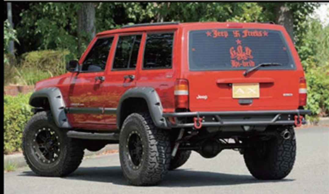
45インチアップにオーバーフェンダーを装着。285サイズのタイヤをバランス良く収めている。
