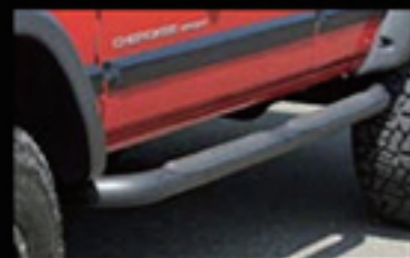
ワイド化したボディとのマッチングが良いスミティピルトのシェアステップ。
