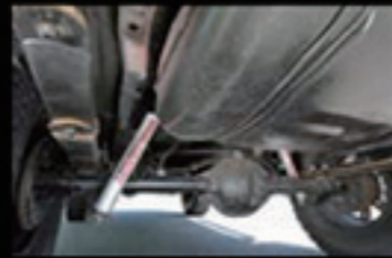
リアサスペンションもキットに付属。プロックを使わずリフトで車高をアップさせる。
