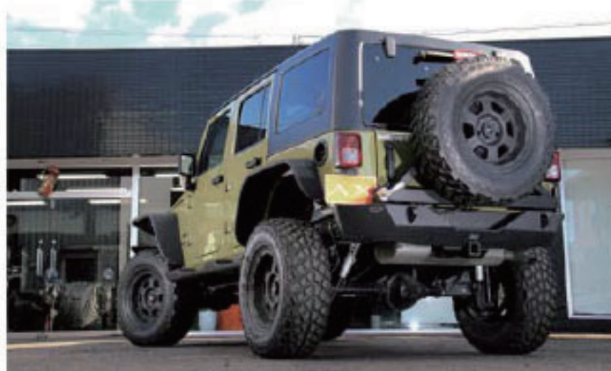
スミッタビルトのXRCリアバンパー、タイヤキャリアはこのようにスイングする。
