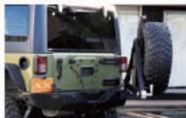
スミッタビルトのXRCリアバンパー、タイヤキャリアはこのようにスイングする。
